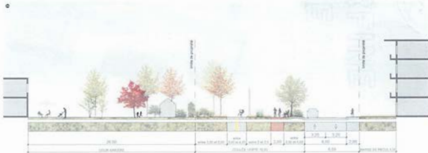
Fig. 199. Coupe type d'une piste multifonctionnelle
