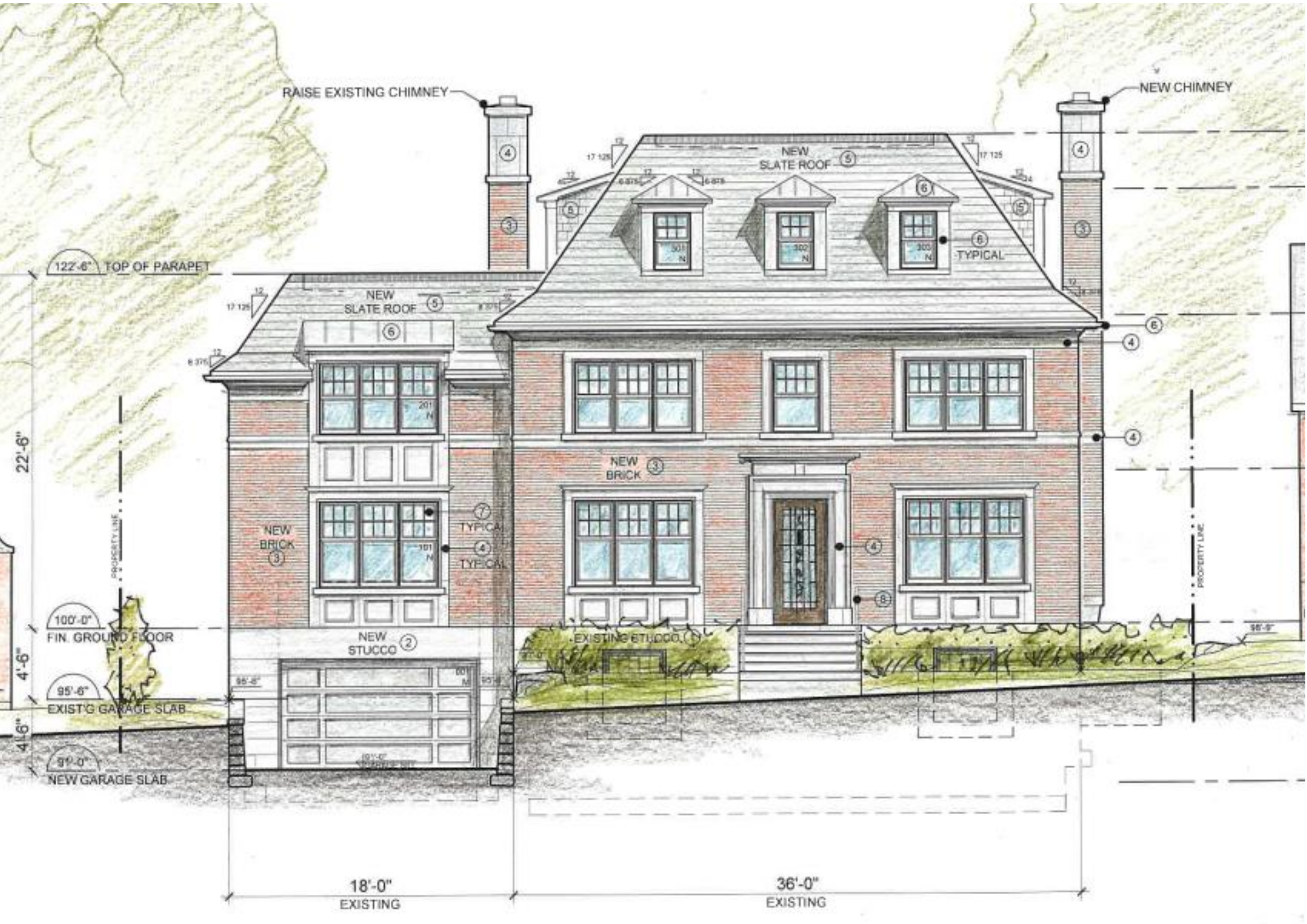
Élévation avant / Front elevation
