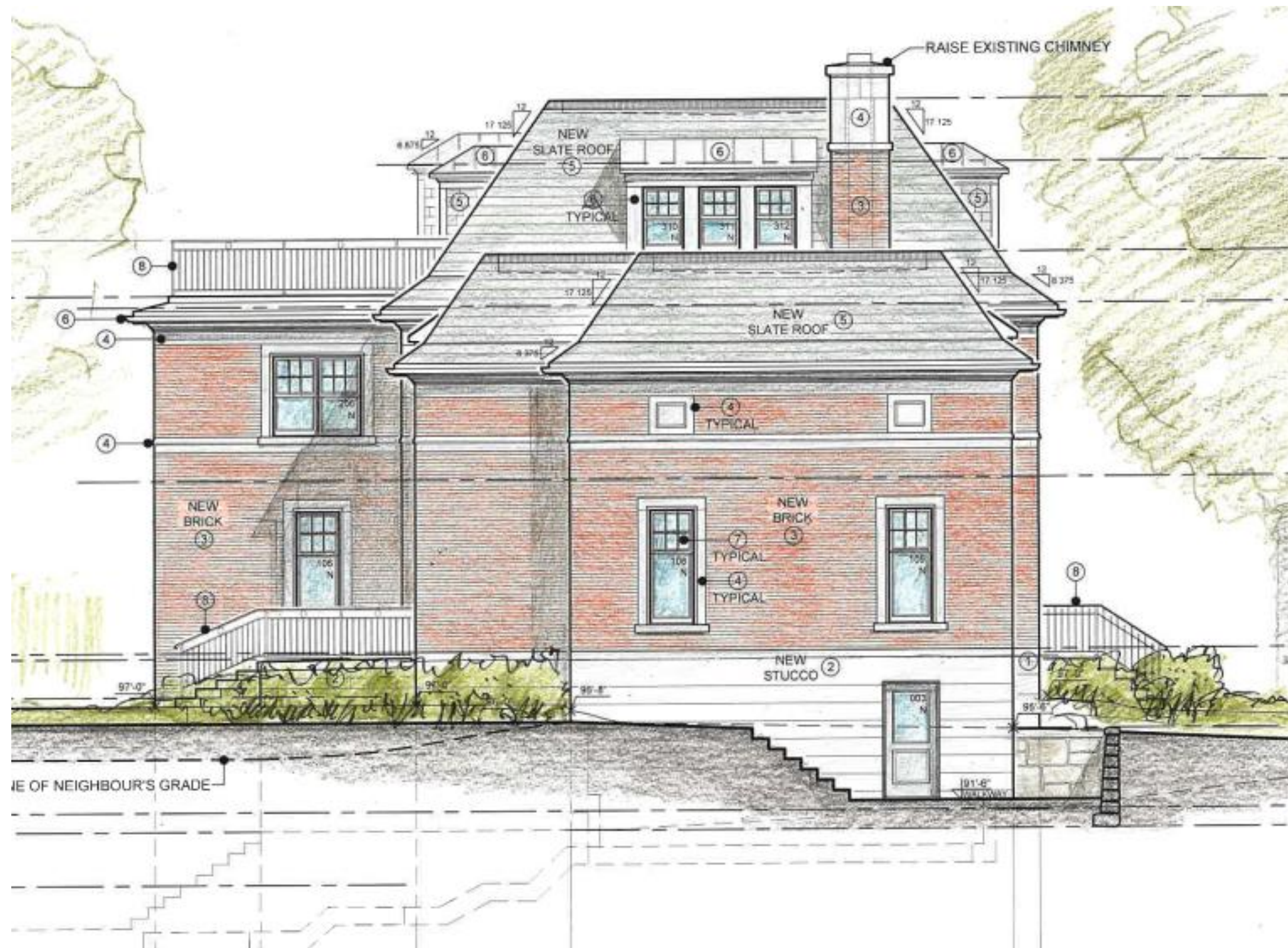
Élévation latérale ouest / West elevation
