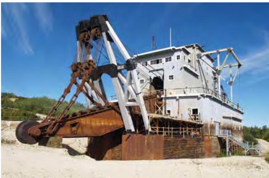
La lourde charpente en bois détériorée du pont roulant avant de la Drague Numéro Quatre à Dawson, au Yukon, a été démantelée et remplacée à l'identique par une nouvelle charpente construite avec de nouvelles pièces de bois de la taille des pièces originales, mais avec toutes les ferrures et tous les montages d'origine. Le pont roulant avant, qui soutient l'échelle de drague, est un élément construit important dans la conception fonctionnelle de la drague.
